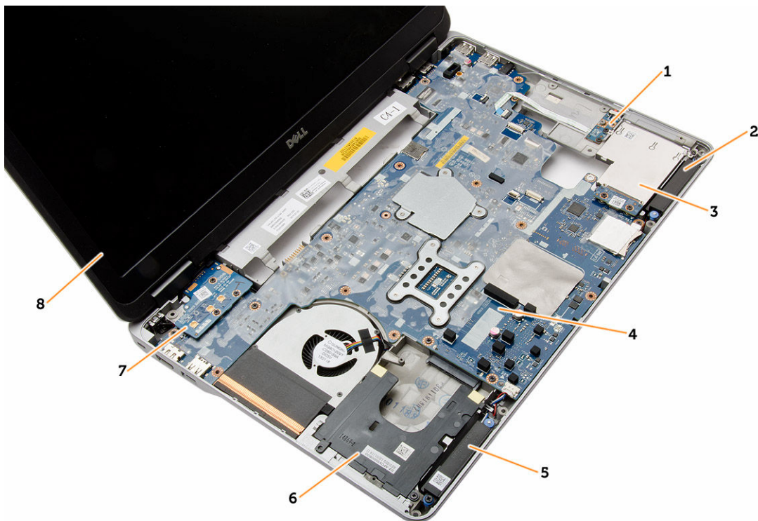
Rysunek 2. Widok z góry — po wymontowaniu klawiatury i zestawu podparcia dłoni
